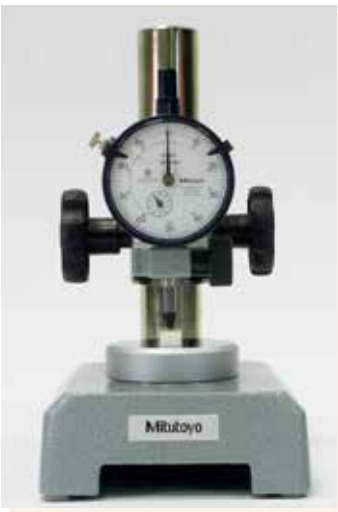
Nollapisteen asetus 10 mm:n keraamisella mittapalalla jos työkappaleen nimellismitta on 10 mm
